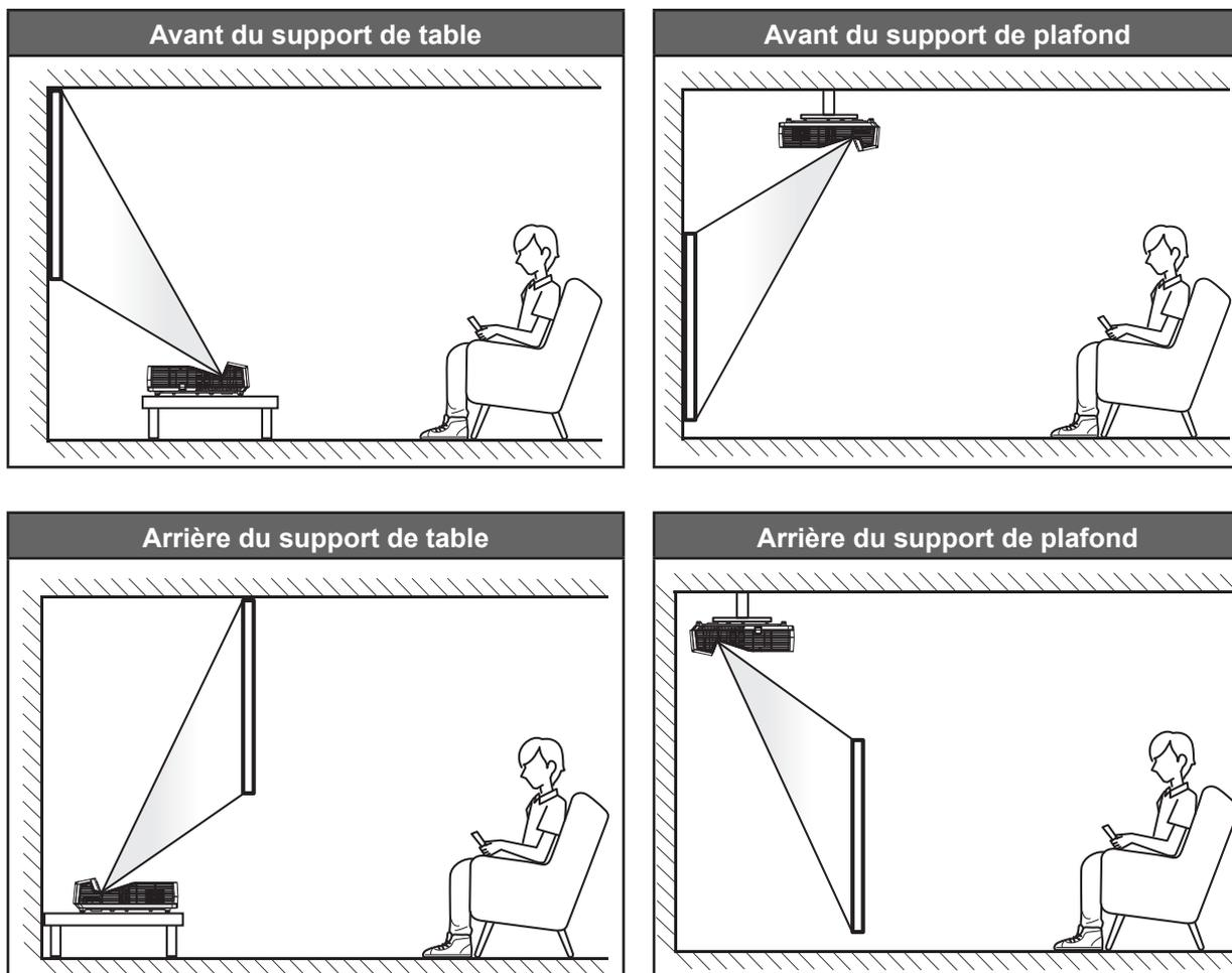
Le projecteur doit être placé à plat sur une surface plane et à 90 degrés/à la perpendiculaire de l'écran.
