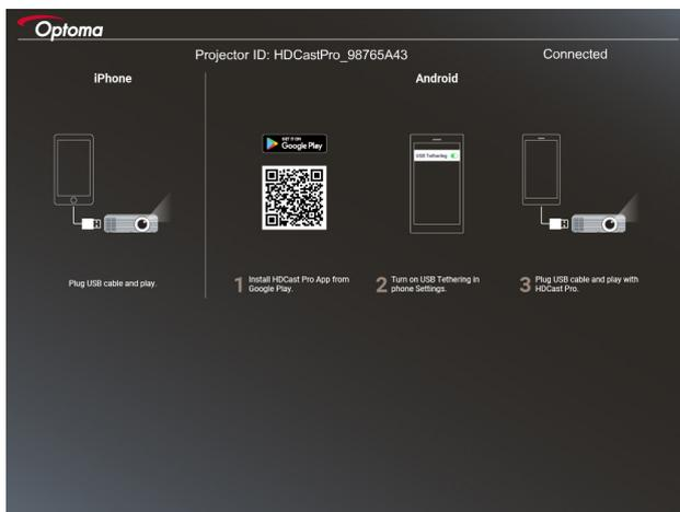
b) Raccordez le projecteur et votre appareil intelligent avec un câble USB. L'écran de votre appareil intelligent va automatiquement être mis en miroir sur le projecteur.
