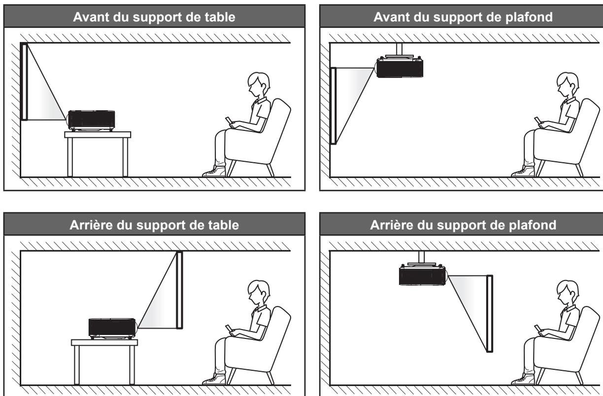
Le projecteur doit être placé à plat sur une surface plane et à 90 degrés/à la perpendiculaire de l'écran.
